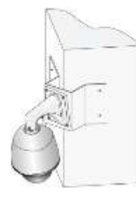
Монтаж на угол
